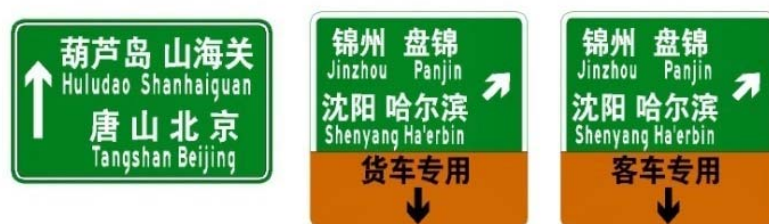
图 8.5.3-1 双车道匝道起点处预告标志示例
