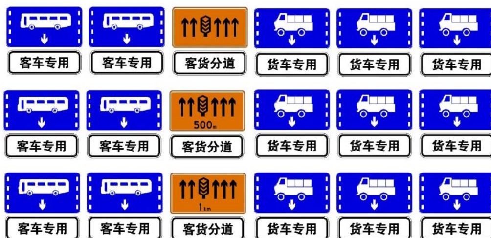
图 8.5.1-3 减速车道渐变段起点前 1km、500m、渐变段起点处预告标志示例
